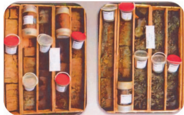
Eșantioane prelevate din terenul de fundare
