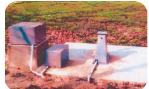
Foraj de medie adâncime pentru urărirea la risc seismic al zonei
