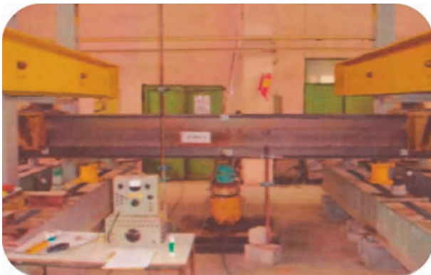
Grindă metalică solicitată la solicitări compuse
